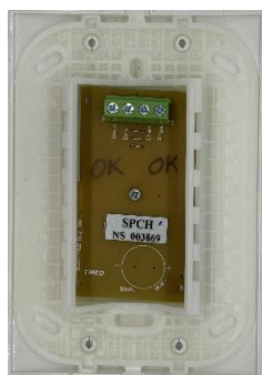
Figura 20 - Vista posterior do Sinalizador de Porta (SP) sem Sonalarme
