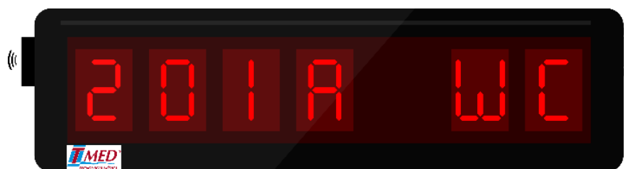
Figura 11 - Acionamento da Unidade de Chamada do Banheiro
