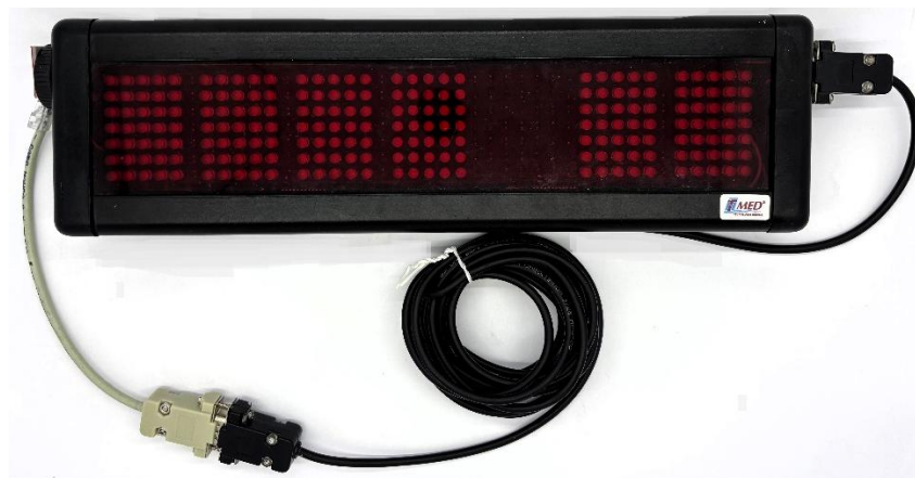
Figura 20 - Display Digital conectado com cabos extensor e DB9 - RJ45
